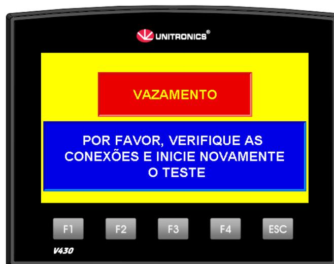
Figura 7 – Tela de Vazamento durante a estabilização
