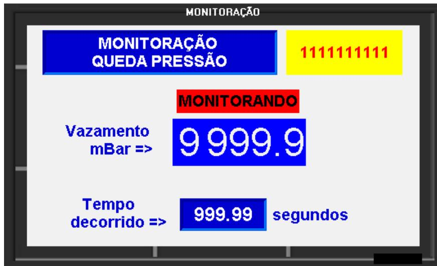
Figura 8 – Tela de Monitoração do Vazamento
