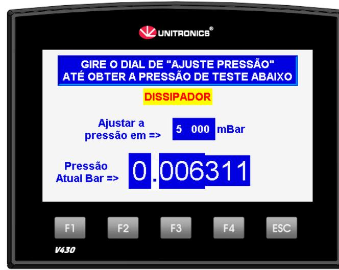
Figura 4 – Tela de Ajuste de Pressão de Teste
