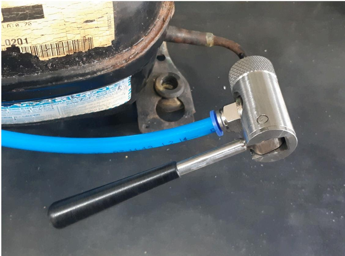
Figura 8 – Klamp de pressão no passador de cobre (saída) do compressor
