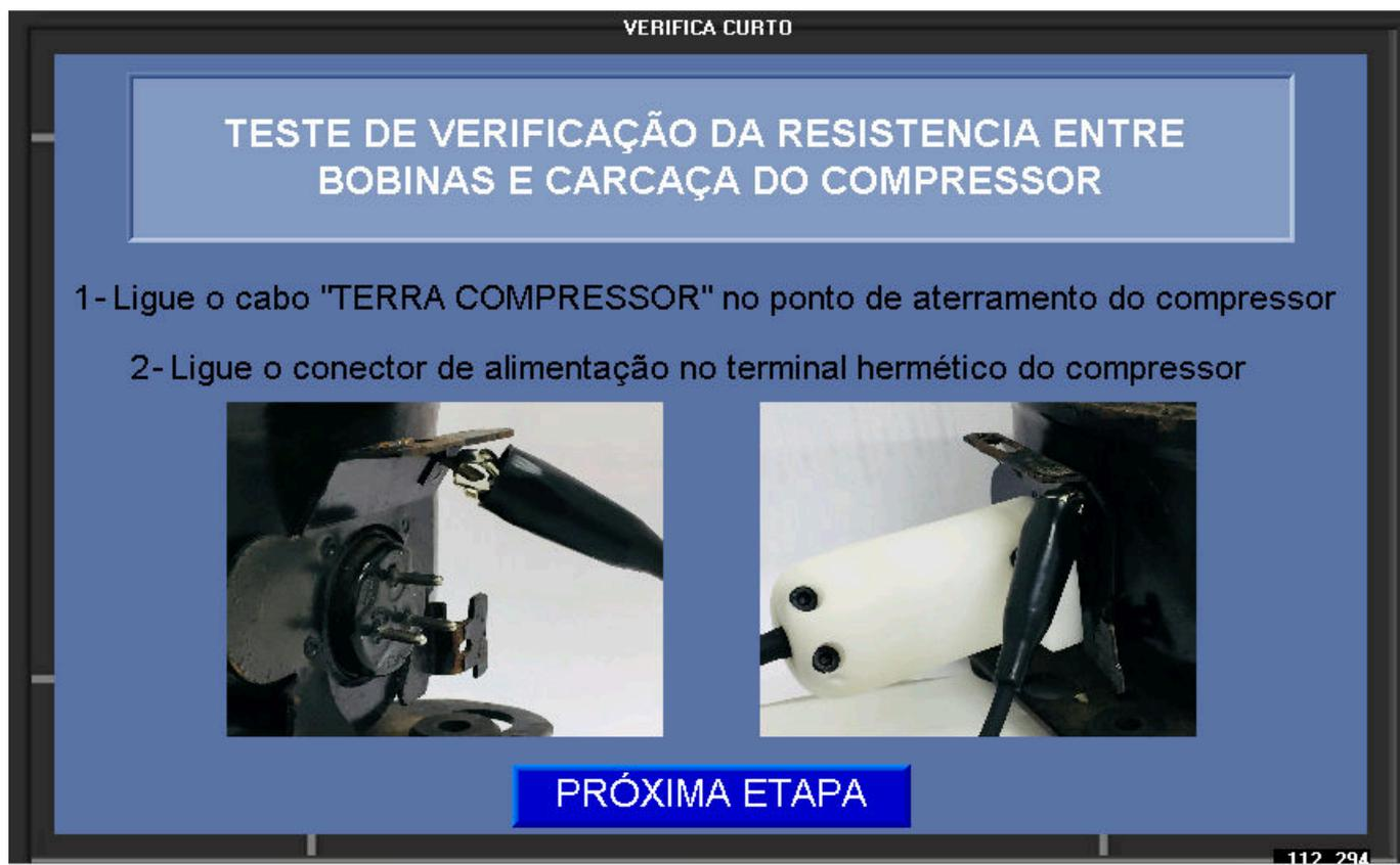
Figura 5 – Tela de orientação de conexão dos cabos para verificação de curto contra carcaça do compressor
