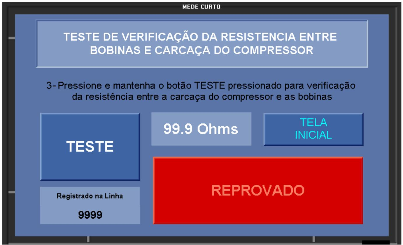
Figura 6 – Tela teste de curto entre carcaça do compressor e bobinas
