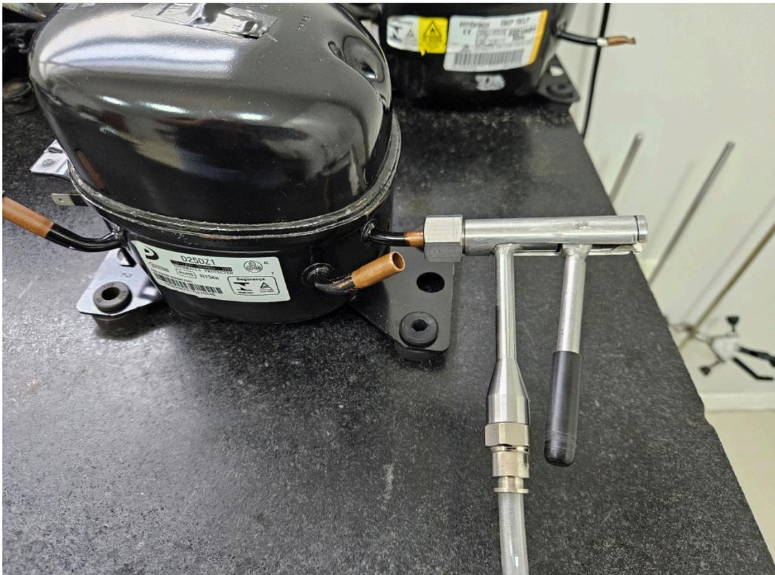
Figura 8 – Alicete de pressão no passador de cobre (saída) do compressor
