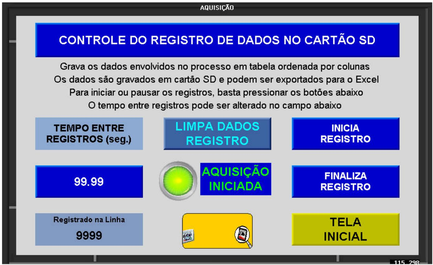
Figura 10 – Tela de aquisição de dados
