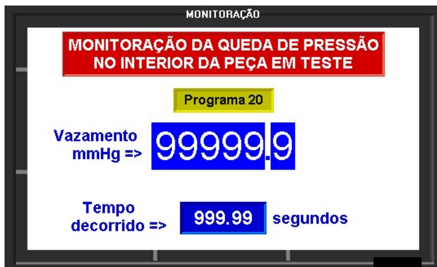
Figura 8 – Tela de Monitoração do Vazamento
