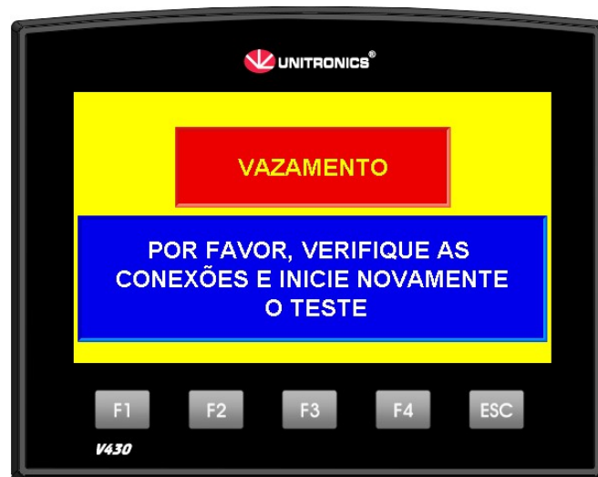
Figura 7 – Tela de Vazamento durante a estabilização
